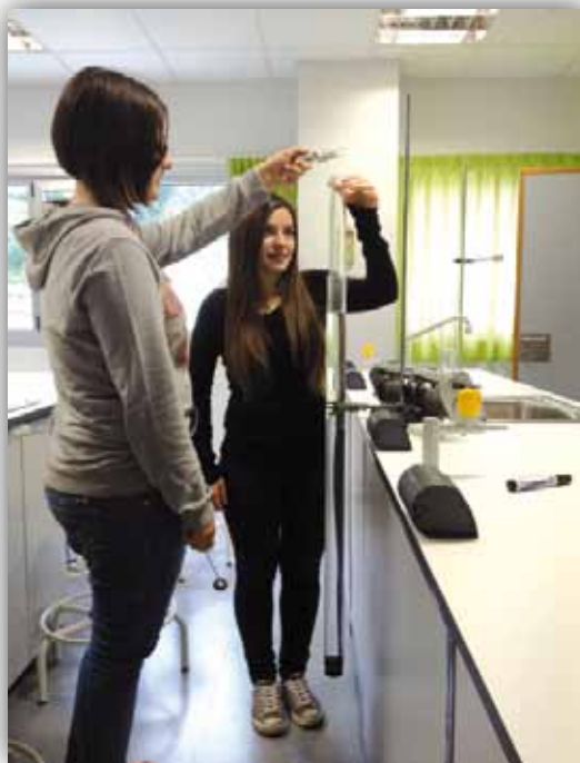
Figura 1. Imagen de alumnas de 2.º de Bachillerato determinando la velocidad del sonido en el aire. Realización propia.
