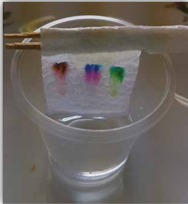
Figura 2. Prueba de un diseño experimental para obtener los cromatogramas de tres colores diferentes.
