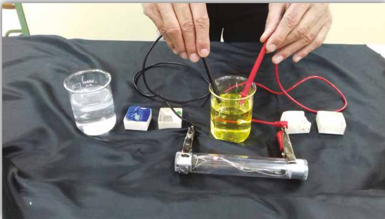
Figura 9. Montaje individual para medir conductividades.
