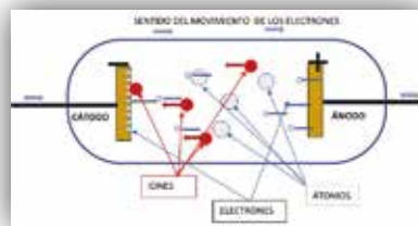
Figura 12. Esquema del interior de un tubo de descarga de gases.
