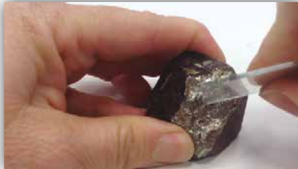
Figura 2. Imagen tomada en el laboratorio para determinar la dureza de la pirita.
