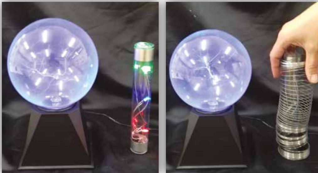
Figuras 16 y 17. Comprobación del efecto jaula de Faraday con un muelle metálico.
