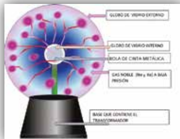
Figuras 3 y 4. Modelos de bolas de plasma. Esquema de los componentes.
